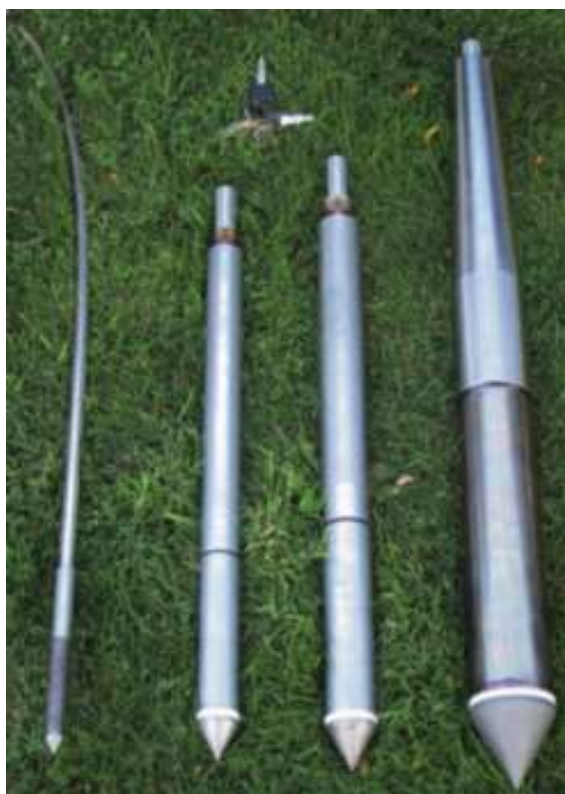
Figura A4.2 Range di variazione delle sonde per prove CPT: da sinistra: 2 cm 2 , 10 cm 2 , 15 cm 2 , 40 cm 2 (da Robertson, 2015).
