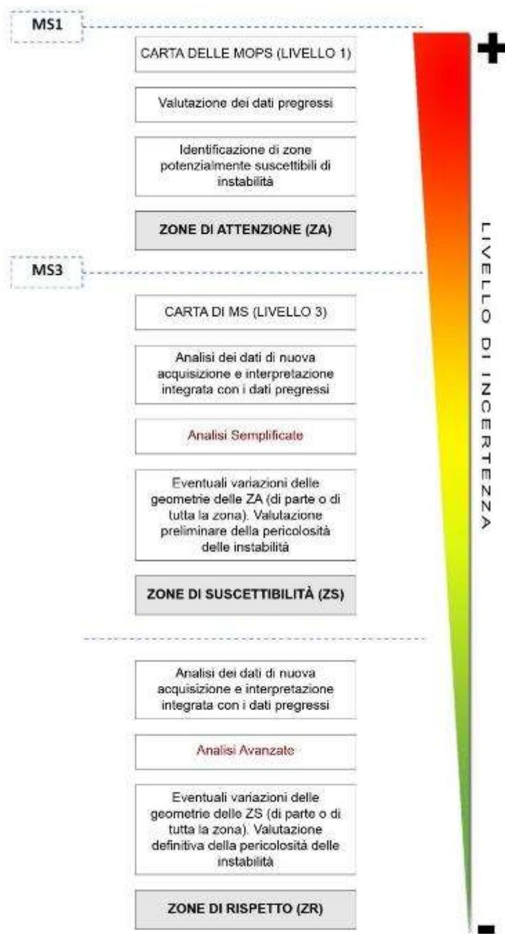
**Figura 1-1** - Schema illustrativo del tipo di zona di instabilità nelle carte delle MOPS e di MS. La raccolta dati e la tipologia di analisi permettono di ridurre le incertezze procedendo dal livello 1 al livello 3.
